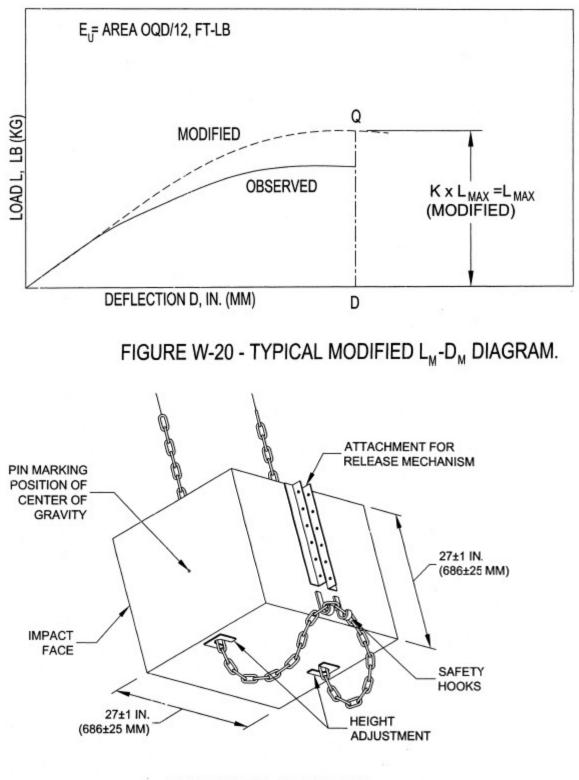
FIGURE W-21 - PENDULUM.
